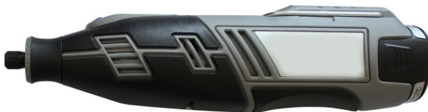
Рисунок 5 - Внешний вид электропривода расточного приспособления.
